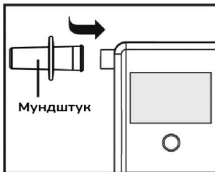
Нажмите и удерживайте кнопку Тест (Test) до включения. Раздастся звуковой сигнал, на дисплее высветится показание счетчика тестов, после чего пойдет обратный отсчет до нуля. В течение этого времени происходит самотестирование прибора и разогрев датчика. На дисплее высвечивается надпись WAIT (Ждите). По завершении отсчета прозвучит звуковой сигнал готовности к продуванию.
